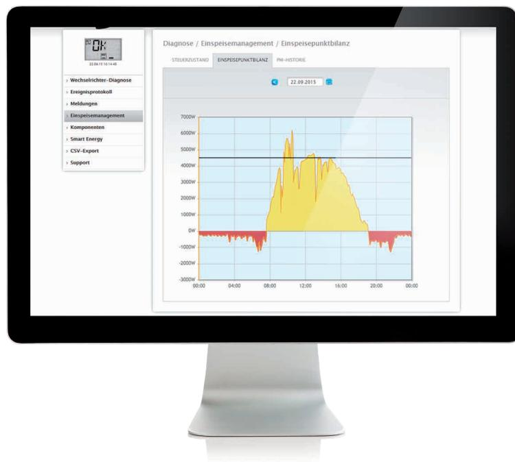
**Einspeisemanagement – Einspeisepunktbilanz:** In diesem Diagramm wird auf einen Blick ersichtlich, wann welche Leistung ins öffentliche Netz eingespeist wird und wann welche Leistung aus dem Netz bezogen wurde. Die negativen (rot) Werte stellen den Bezug aus dem Netz dar und die positiven (gelb) Werte die Einspeisung ins Netz.
