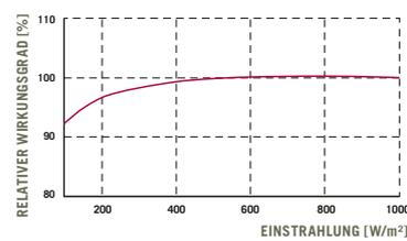
Typische Modulleistung unter niedrigen Einstrahlungsbedingungen im Vergleich zu STC-Bedingungen (25 °C, 1000 W/m<sup>2</sup>).
