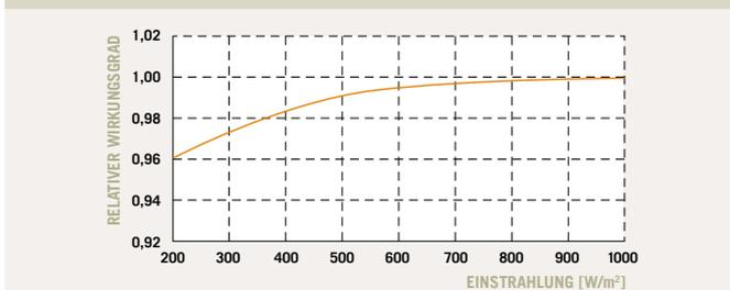
Die typische relative Änderung des Modulwirkungsgrades bezogen auf die Nennleistung bei einer Einstrahlung von 200 W/m<sup>2</sup> im Verhältnis zu 1000 W/m<sup>2</sup> beträgt -4 % rel. (gemessen bei 25 °C, AM 1,5 Spektrum).
