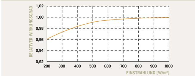
Die typische relative Änderung des Modulwirkungsgrades bezogen auf die Nennleistung bei einer Einstrahlung von 200 W/m<sup>2</sup> im Verhältnis zu 1000 W/m<sup>2</sup> beträgt -4 % rel. (gemessen bei 25 °C, AM 1,5 Spektrum).
