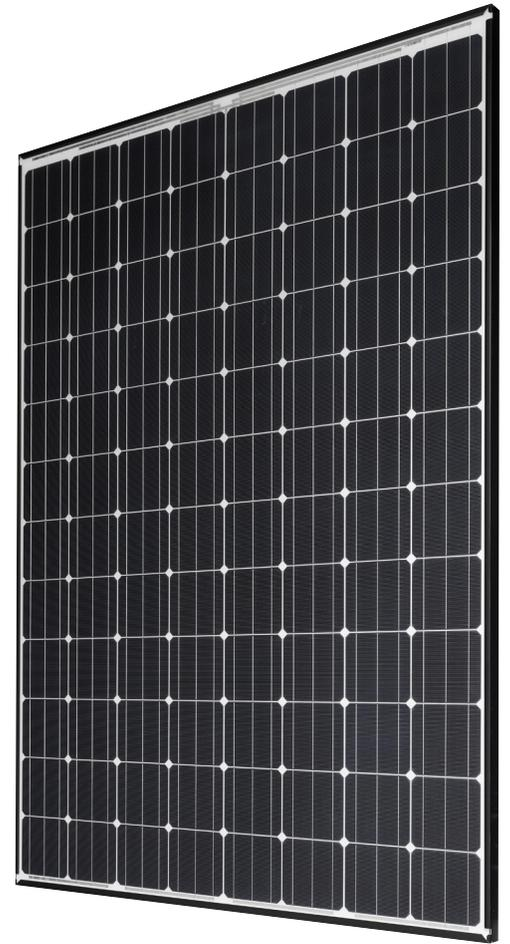
Unser starkes Panasonic HIT<sup>®</sup> N340 besitzt einen hohen Modulwirkungsgrad von 20,0 %, einen branchenführenden Temperaturkoeffizienten von  $-0,258 \text{ \%}/^{\circ}\text{C}$  und ein schlankes Design. Kraftvoll und effizient, damit Sie Ihr Dach bestmöglich nutzen können!
