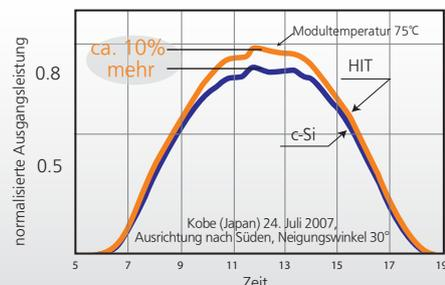
Die HIT Solarzelle und das HIT Modul haben auch bei Massenproduktion einen sehr hohen Wirkungsgrad.
