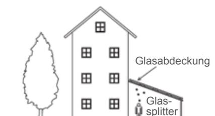
In allen Fällen besteht die grundsätzliche Gefahr, dass Glasmodule beschädigt werden und Passanten durch herabfallende Glasscherben gefährdet werden können. Dabei ist es grundsätzlich unerheblich, ob Glasmodule durch Eigenversagen (Spannungen im Glas, falsche Montage, Thermische Spannungen usw.) zu Bruch gehen, oder ob Module durch externe Einflüsse zerstört werden.
