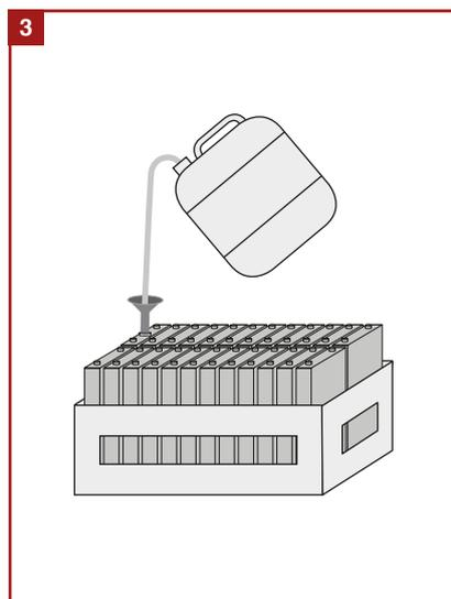
**Akku befüllen:** Prüfen Sie alle Kabel und Verbindungen auf festen Sitz. Befüllen Sie die Akkuzellen mit destilliertem Wasser.
