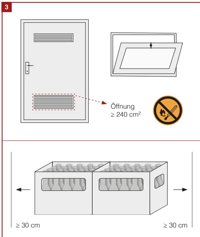
**Raumbeschaffenheit am Montageort:** Planen Sie ein, dass der Raum nach VDE folgende Kriterien erfüllen muss: 8,5 m<sup>3</sup>/h Luftstromvolumen. Bei fehlender natürlicher Luftzufuhr Zwangsbelüftung herbeiführen (min. 240 cm<sup>2</sup> Öffnung = Türstopper oder Tür lamellen). Beachten Sie Mindestabstände und Gewicht des Speichers (entspricht der Größe von zwei Kästen Bier).
