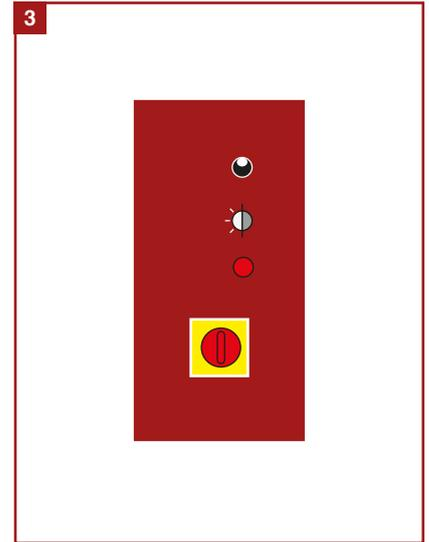
**Netzausfall:** Bypass-Schalter oben, Tastschalter für den Akkubetrieb blinkt, Störungsanzeige leuchtet dauerhaft rot
