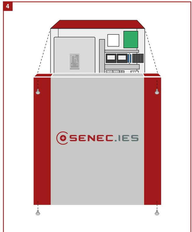
**Gerät verschließen:** Decken Sie den Akku mit dem Akkugehäuse ab und befestigen Sie den Schaltschrankdeckel.
