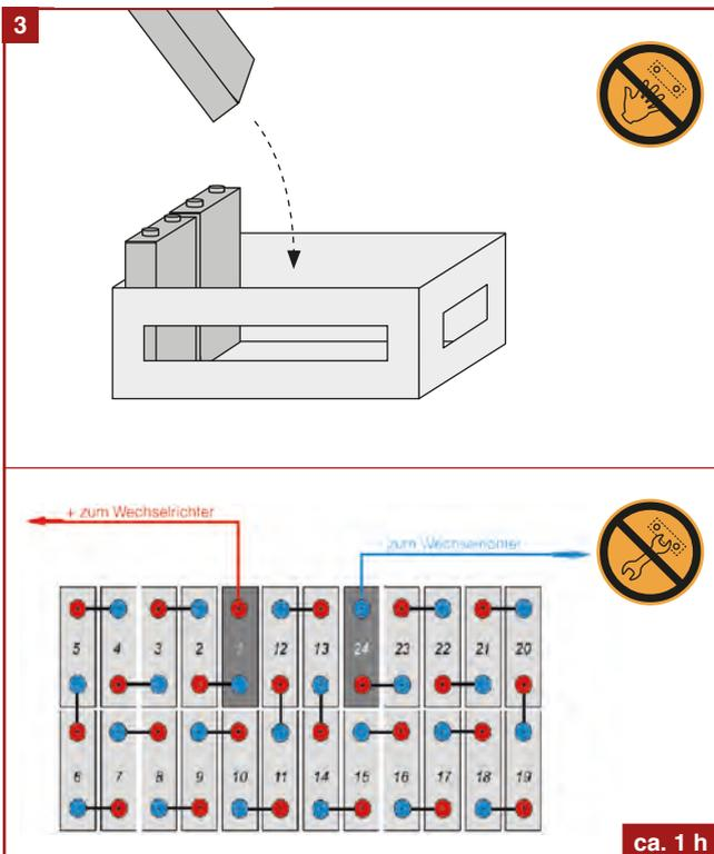
**Aufstellung Akku:** Stellen Sie den Akkutrog in der Nähe des Schaltschranks auf und schichten Sie die Zellen wie vorgegeben nacheinander ein. Vorsicht! Zellen nie waagrecht halten. Verbinden Sie die Pole anschließend gemäß dem Schema.
