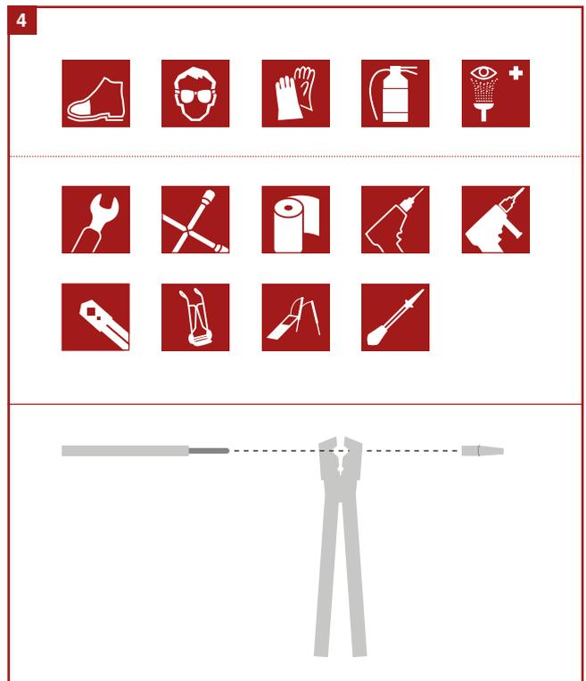
**Werkzeuge, Schutzausrüstung und Vorbereitungsarbeiten:** Planen Sie ein, welches Werkzeug Sie benötigen und welche Schutzausrüstung benötigt wird. **WICHTIG:** Bereiten Sie das DC-Batteriekabel schon vor Montagebeginn vor (Maximallänge 2 m)!
