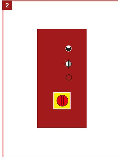
**Bypassbetrieb:** Bypass-Schalter oben, Tastschalter für den Akkubetrieb blinkt
