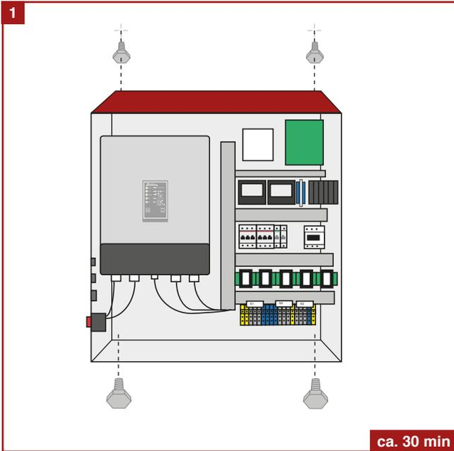
**Montage-Schaltschrank:** Befestigen Sie den Schaltschrank an der Wand, indem Sie den Schaltschrank zuerst in der oberen Verschraubung einhängen. Befestigen Sie dann die unteren Schrauben.
