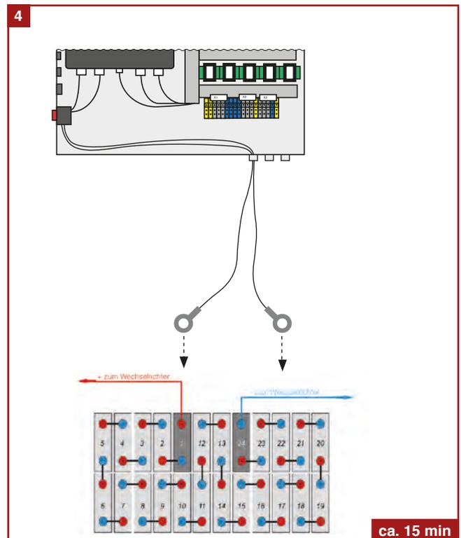
**DC-Installation:** Befestigen Sie die DC-Kabel zuerst mit dem Lasttrennschalter und verschrauben Sie diese dann mit dem Akku. Beginnen Sie mit der Plus-Verbindung.
