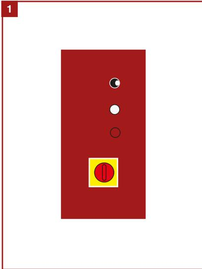
**Normalbetrieb:** Bypass-Schalter rechts, Tastschalter für den Akkubetrieb leuchtet dauerhaft
