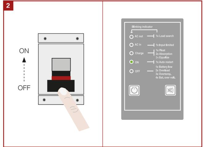
**Dann AC-Strom zugeben:** Schalten Sie dann das Hausnetz zu. Ihre Anlage ist vollständig in Betrieb.
