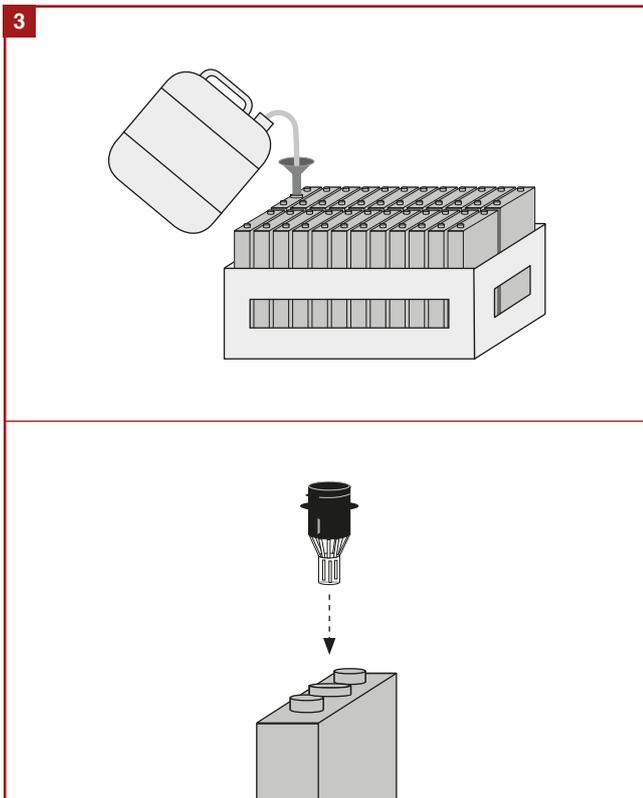
**Akkus befüllen:** Befüllen Sie die Akkus nun mit destilliertem Wasser und befestigen Sie die Befüllstopfen in den Akkuzellen. Das Vorgehen mit Handfüllstopfen bzw. Rekombinationsstopfen ist ausführlich in der Installationsanleitung erklärt.
