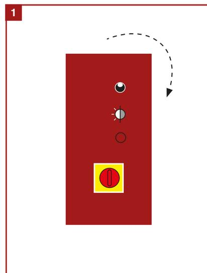
**Bypass wegschalten:** Schalten Sie den Batteriestrom wieder zu. Verschließen Sie den Akku.
