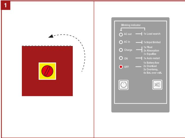
**Erst DC-Strom anstellen:** Schalten Sie den Lasttrennschalter auf „Ein“. Das Signal am Batterie-wechselrichter bestätigt den Eingang.
