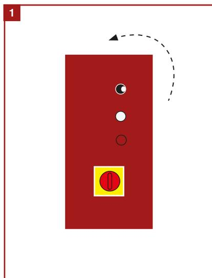
**Bypass einschalten:** Trennen Sie den Batteriestrom vom Hausstrom.
