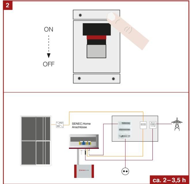
**AC-Installation:** Schalten Sie den Hausstrom ab. Trennen Sie die Verbindung hinter dem Zweirichtungszähler und der Phase mit den Verbrauchern zur Hausverteilung und stellen Sie die AC-Verbindung zum Schaltschrank her.
