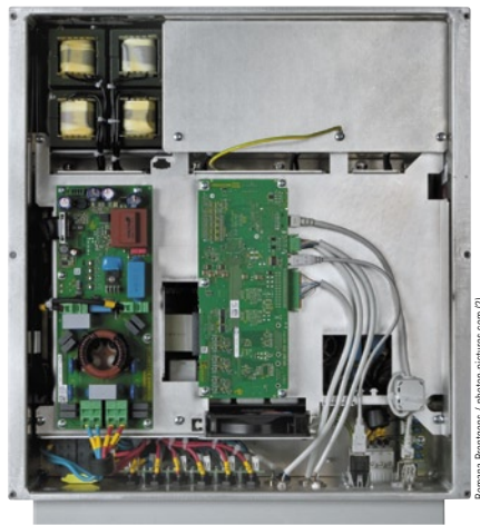
▲ Das Innenleben des Sinvert PVM20 ist sehr kompakt organisiert. Das Wärmebild zeigt keinerlei Auffälligkeiten, wobei der Thermografiekamera allerdings der rückwärtig hinter den Leiterkarten platzierte Leistungsteil verborgen bleibt.
