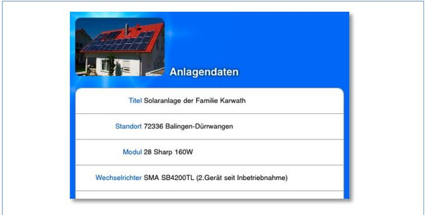
Die Datenansicht zeigt Ihnen den eingetragenen Eigentümer, den Standort der Anlage, die installierten Module und Wechselrichter sowie Leistung und Ausrichtung der Anlage und das Datum ihrer Inbetriebnahme.
