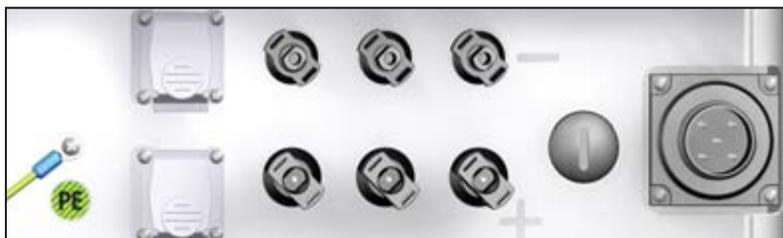
Der Ableitstrom des Wechselrichters liegt ohne eine Verbindung zum Solargenerator unterhalb von AC 3.5 mA. Ist der Solargenerator in Betrieb, kann der Ableitstrom am Wechselrichter den Wert von AC 3.5 mA jedoch weit überschreiten. In diesem Fall ist ein zweiter, fester Schutzleiteranschluss nach EN 50178 gefordert. Der Querschnitt des zweiten Schutzleiters sollte mindestens den gleichen Querschnitt wie der des Hauptanschlusses aufweisen.
