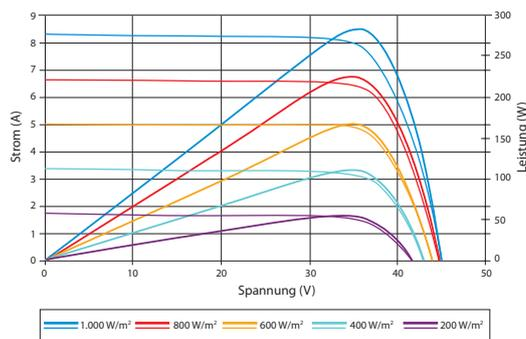
Hervorragende Leistung bei schwachem Licht: bei einer Strahlungsintensität von 200 W/m² (Luftmasse 1,5, 25 °C) ist ein relativer Modulwirkungsgrad von mehr als 95,5% gegenüber Standardtestbedingungen (1.000 W/m²) erreichbar.
