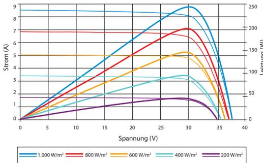
Hervorragende Leistung bei schwachem Licht: bei einer Strahlungsintensität von 200 W/m² (Luftmasse 1,5, 25 °C) ist ein relativer Modulwirkungsgrad von mehr als 95,5% gegenüber Standardtestbedingungen (1.000 W/m²) erreichbar.
